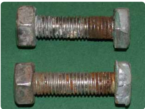
Rustfrie bolte med korrosion i gevindet
