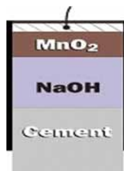
Snit gennem ERE 20 referenceelektroden
