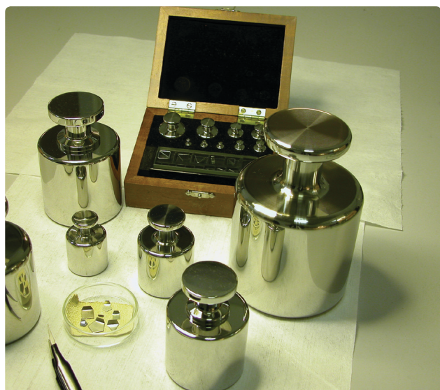
Kalibrering av lodd og verifisering av vekter.
