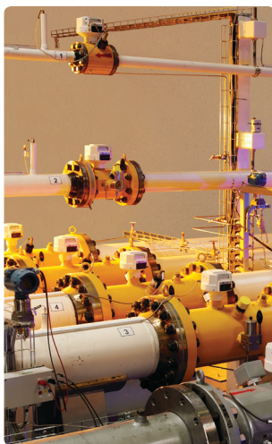
Høytrykkskalibrering av volumgassmålere og strømningsmålere med naturgass som prøvemedium.
