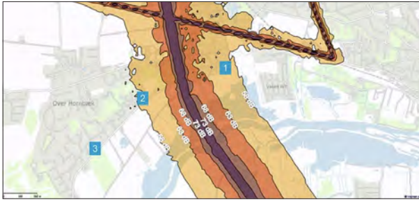
Figur 2. Støjkort med L_{den} langs motorvej E45 ved Gudenåbroen. Fra Vejdirektoratets strategiske støjkort (2012).
