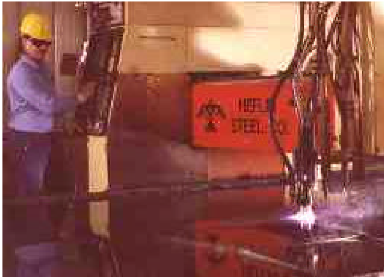
Figur 3.166 Plasmaskæring på vandbord sikrer det bedste arbejdsmiljø.
