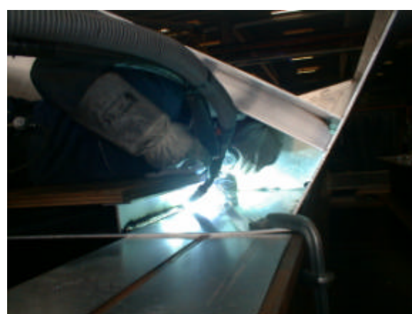
Figur 2.157 Svejsning af inderste longitudinal. Bemærk den korte afstand fra ansigt til lysbue.
