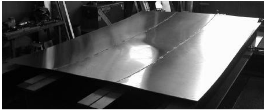
Figur 3.159 Svejste plader med sprædd, der efterfølgende blev rettet op ved hamring.
