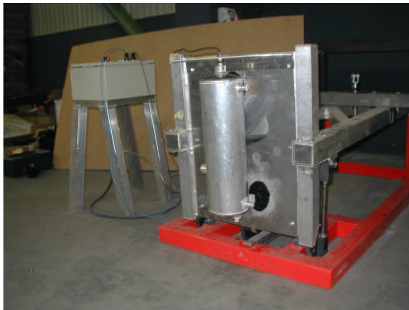
Figur 4.37 Mekanisk prøvning af prototype til dræntank.
