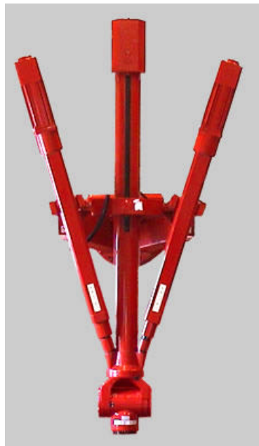
Figur 3.124 Robot med stor stivhed egnet til FSW i mindre tykkelser (NEOS Robotics).
