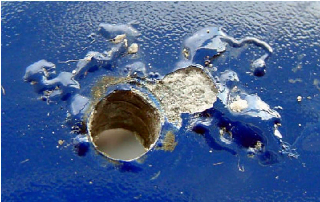
Figur 6.28. Filiform-lignende underkorrosion omkring skruehul, hvor skrue af rustfrit stål har været monteret. Det er vist hvorledes underkorrosionens udstrækning er bestemt som retlinede afstand fra hullets kant til korrosionens fjerneste punkt. i dette tilfælde er udstrækningen lig 8 mm.
