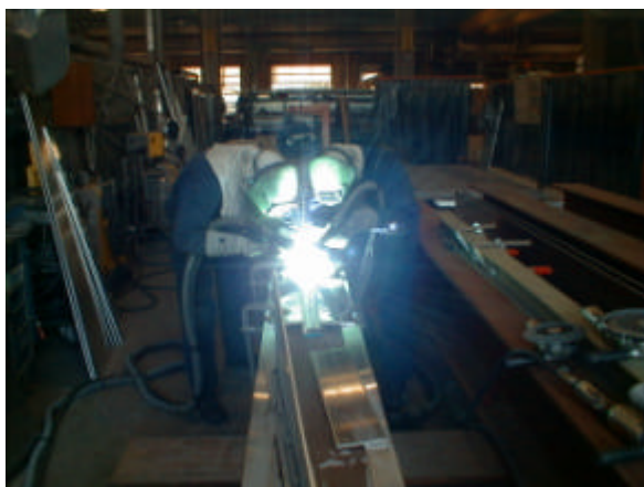
Figur 2.150 Tosidet svejsning af girder.
