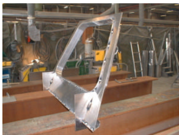
Figur 2.171 Vindues ramme hæftet, bemærk vinkelhjulpebeslagene, model C2.
