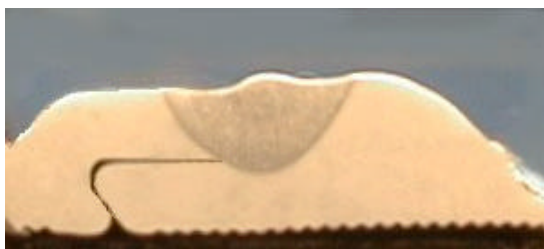
Figur 3.2 Tværsnit af svejsning mellem to ekstruderede profiler med indbygget rodstøtte (T-floor, Mærsk Container Industri A/S).
