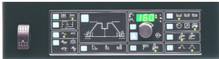
Figur 3.26 Eksempel på betjeningspanel til større TIG svejsemaskine.
