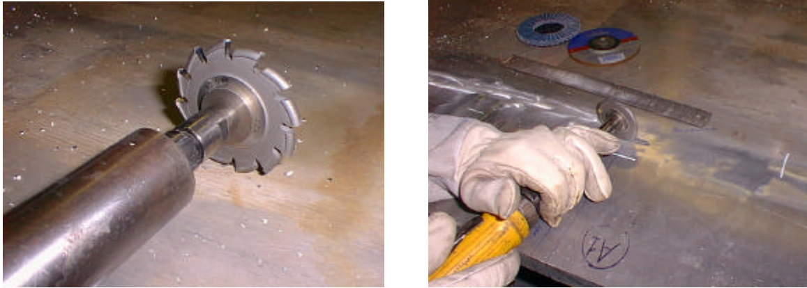
Figur 3.175 Lille luftdrevet fræser til oprensning af rodside eller fjernelse af svejsefejl.
