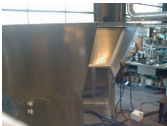
Figur 2.166 Opstillede og hæftede delpaneler, model C1.
