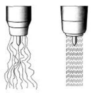
Figur 3.73 Princip ved gaslinse.
