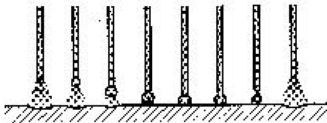
Figur 3.42 Trådafsmeltning ved kortbue MIG-svejsning.
