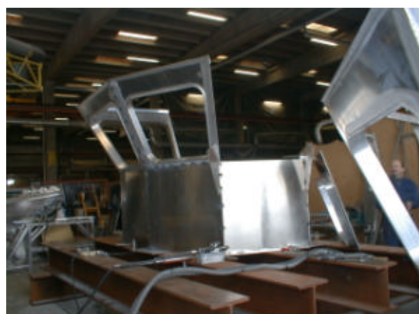
Figur 2.172 Styrehus paneler (C2) ophæftet. Bemærk hjælpebeslagene, så den rigtige vinkel fås.
