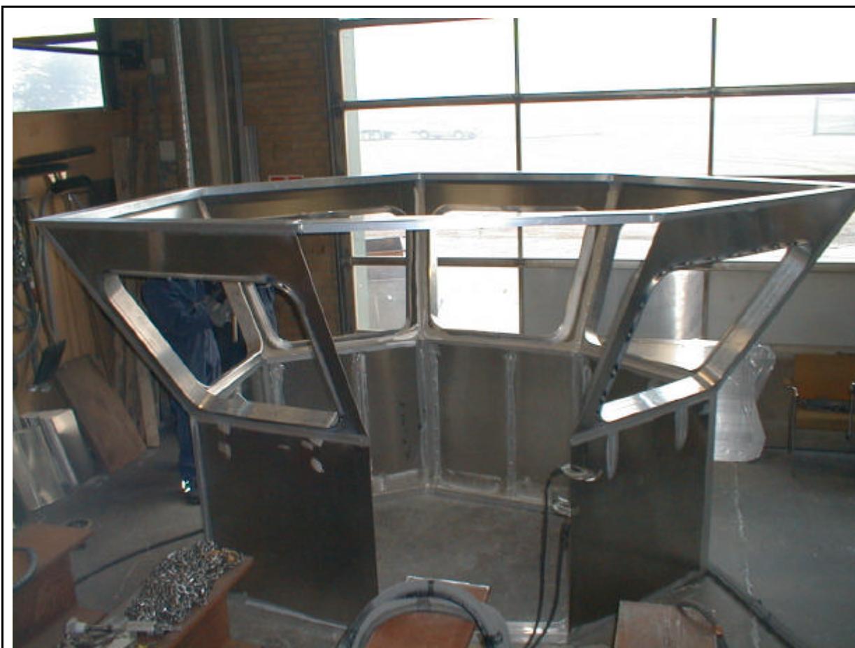
Figur 2.170 Færdigt Styrehus C1, vinduesrammer endnu ikke svejst på indvendige side.
