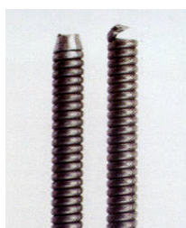
Figur 3.61 Korrekt og ukorrekt tilpasset snudespiral.
