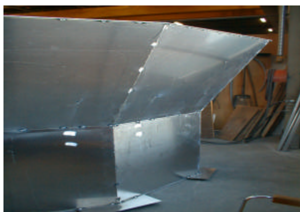
Figur 2.165 Opstillede og hæftede delpaneler, model C1, Bemærk hjælpe vinkelbeslagene nederst på panelerne.
