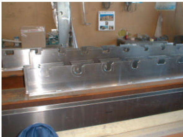
Figur 2.148 Udsavede cut-outs i girder.
