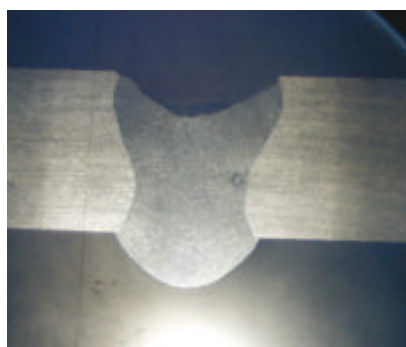
Figur 3.104 Eksempel på uacceptabel nedsynkning af svejsningen. Materiale: 5 mm AA6082, svejst med 4 kW og 1 m/min.
