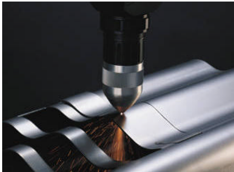
Figur 3.167 Foto af plasmafinstråleskæring.
