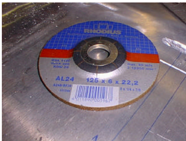
Figur 3.178 Slibeskive til aluminium.
