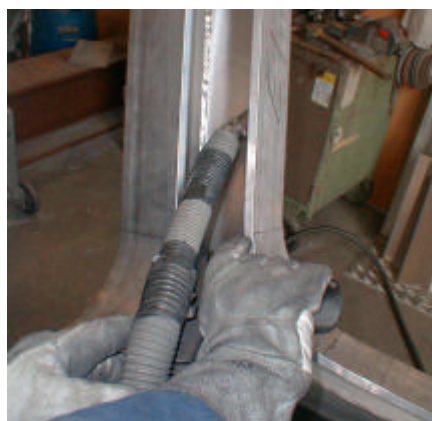
Figur 2.167 Isætning af vinduesrammer i styrehus C1.
