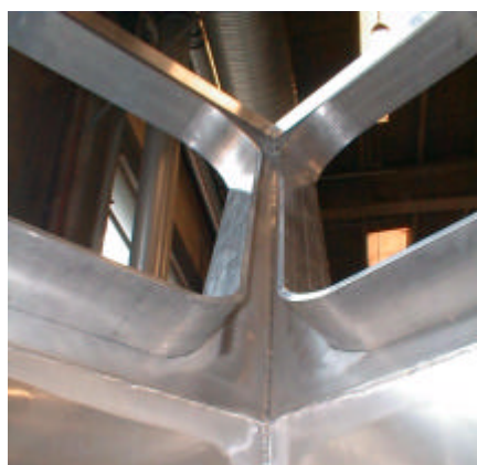
Figur 2.167 Isætning af vinduesrammer i styrehus C1.
