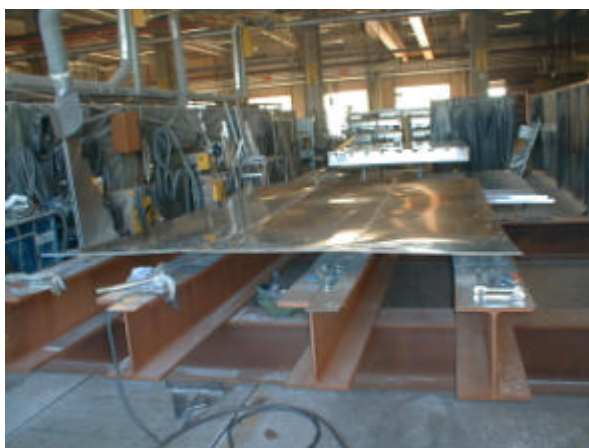
Figur 2.146 Spræl i pladepanelet efter stumpsømssvejsning. Manuel MIG puls svejsning med ESAB 400. U=21,3 V, I=196 A, Svejsehastighed 11,3 m/min, gasflow 20 l/min. Tilsats OK 18.16 Autrod \varnothing 1.2
