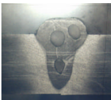
Figur 3.106 Lasersvejsning i 5 mm AA5083 udført med tilsatsmateriale. Lasereffekt 3,5kW, svejsehastighed 1,5m/min og tråd-hastighed 3m/min.
