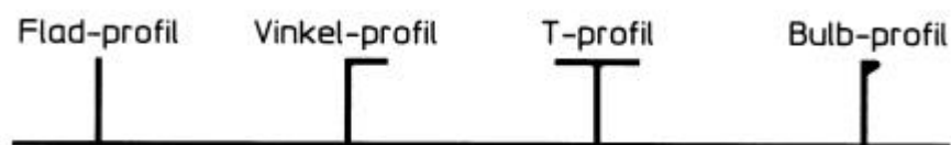
Figur 2.12 Geometri af forskellige typiske profiler
