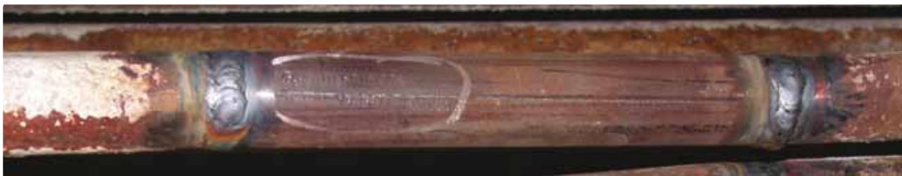
Indsvejste rørprøver i overheder
