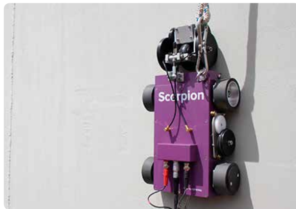
Automatiseret tykkelsesmåling af tanksvøb - Udstyr: Silverwing scorpion crawler
