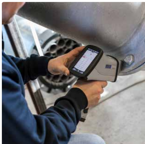
En af de åbenlyse fordele ved mobilt PMI er, at udstyret fungerer på batteri og derfor har en god mobilitet. Dette gør det nemmere at tilgå steder og overflader, der ellers er svært tilgængelige.
