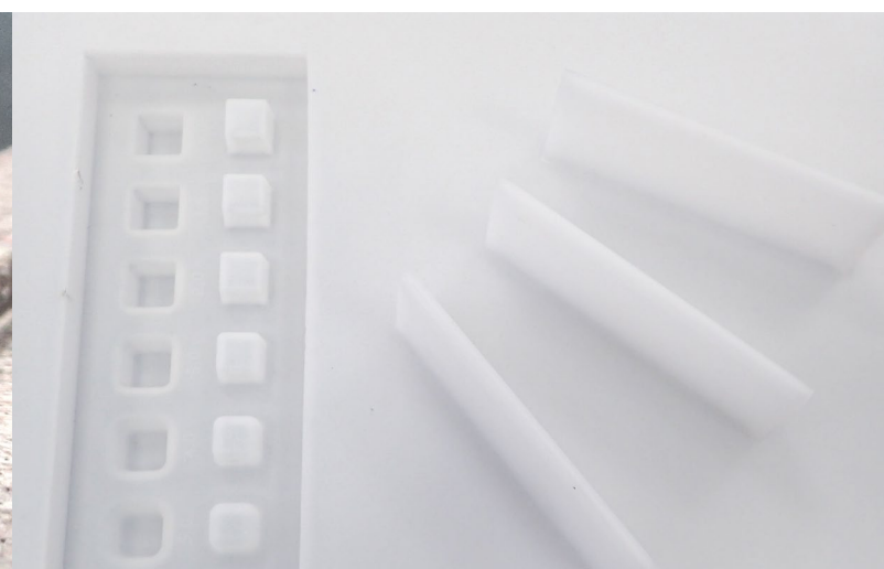
Illustration af hjørner og skarpe kanter, der er svære at få til at stå helt skarpt - her med 100 % nyvare til venstre og 60 % genanvendt materiale og 40 % nyvare til højre. Bemærk, at der her er foretaget forsøg med rotationsstøbning.
