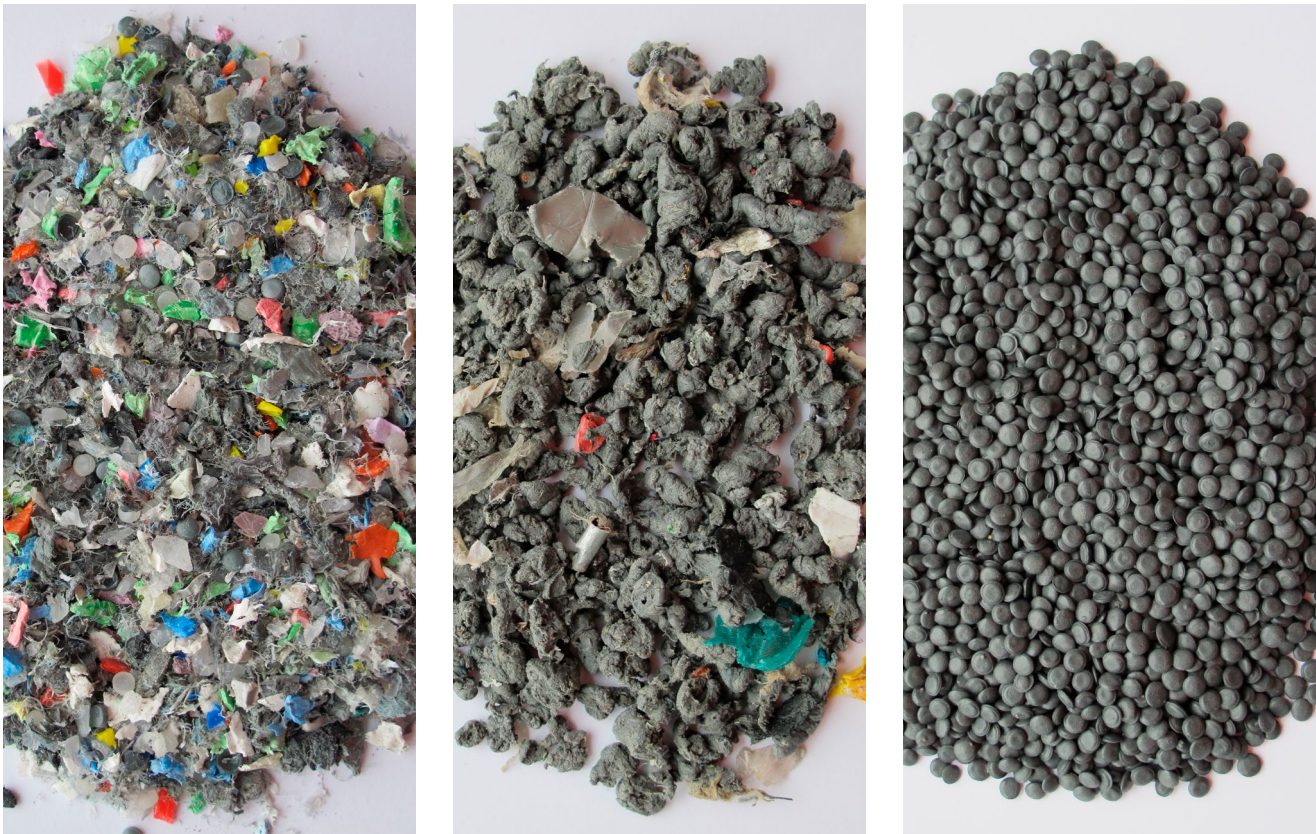
Plast til genbrug - neddelte blanding af genbrugsplast (venstre), forarbejdet agglomerat (midten), genbrugsplast smeltet til pellets (højre)
