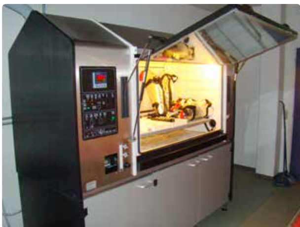
Salttågekammer til test af holdbarhed
