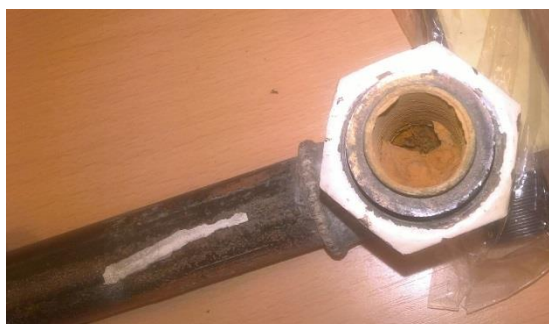
Figur 39 Øverst til venstre lige rør m/u rustangreb. Nederst venstre side: brøndfitting med vinkelventiler (ny), Højre øverst rør og vinkel med rustangreb. Højre nederst viser indløbet.
