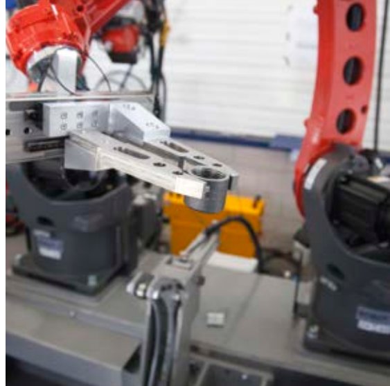
Håndtering, skæring og svejsning udføres af to separate robotter.
