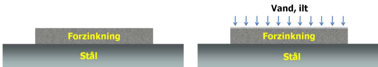
Fig. 5 Vejrliget nedbryder en forzinket overflade til et beskyttende - men svagt - dæklag.
