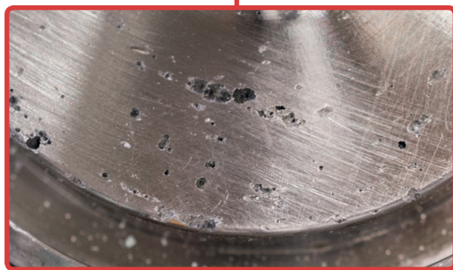
Pittings på ventiltod i rustfri stål.
