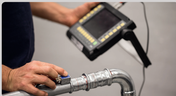
Ultralydprøvning med lille sensorhoved
