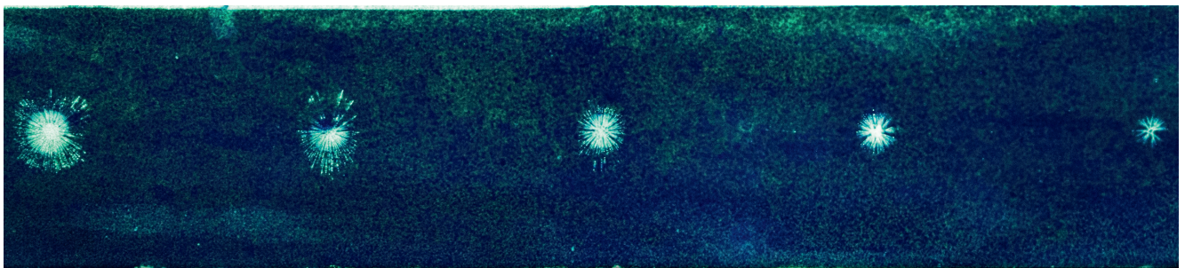
C: Påført penetrant FP-10 og fremkalder Spotcheck SKD-S2.
