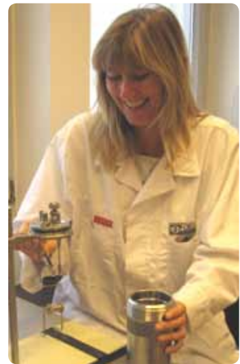
Præparering af 1 g prøve for brændværdibestemmelse
