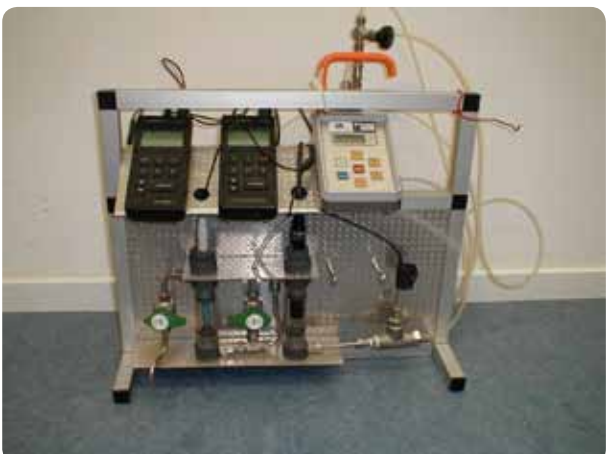
Rack til måling af iltindhold, pH-værdi og ledningsevne
