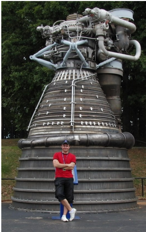
F-1 raketmotoren fra Saturn V raketten. Vægt: 8400kg. Leverer 690 Ton trykkraft dvs. >1½ gange alle Souyz rakettens motorer i 1. og 2. trin tilsammen.
