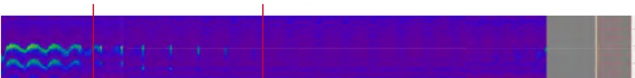
Figur 2 viser signaler fra en rodfejl i svejsningen (mellem de røde streger) Signalet fra rodfejlen er gentaget flere gange i scanningen. Det skyldes at lyd hovedet ser fejlen i flere rotationer, inden fejlen er passeret. Det kan ved fastlæggelse af positionen af indikationen konstateres, at det er den samme indikation, som gentagende gange er registreret. I højre side af billedet ses netop lige rørvæggen efter svejsningen.
