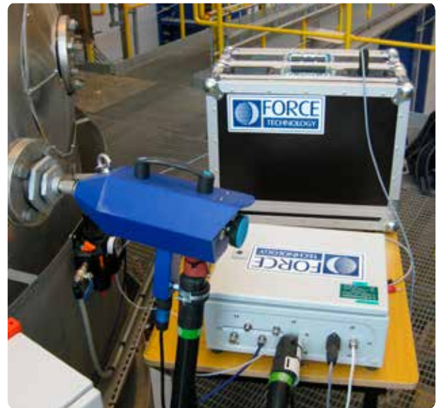
FORCE Technology har udviklet et specialdesignet udstyr til langtidsprøvetagning af den biogene/fossile andel af \text{CO}_2 i røggas
