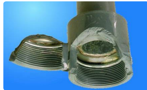
Miljøinduceret spændingsrevnebrud i PVC rørmuffe
